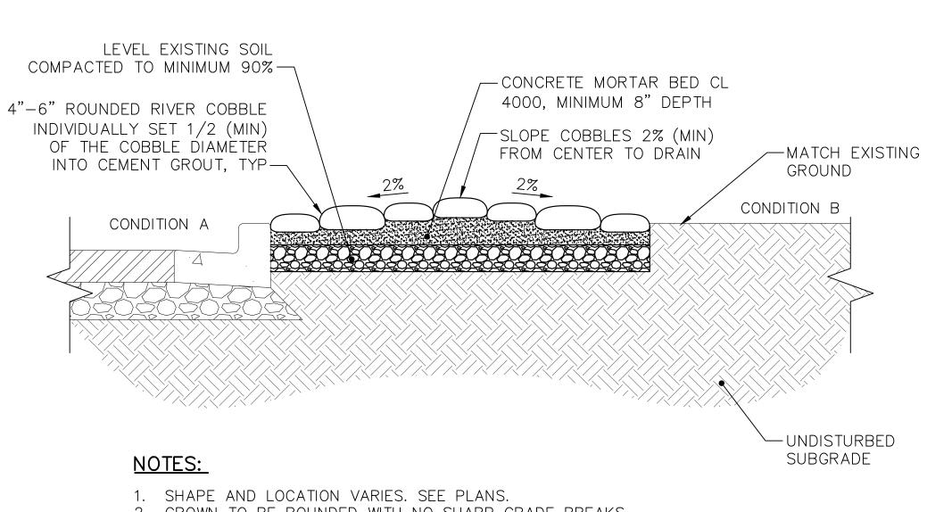
CROWN TO BE ROUNDED WITH NO SHARP GRADE BREAKS.
